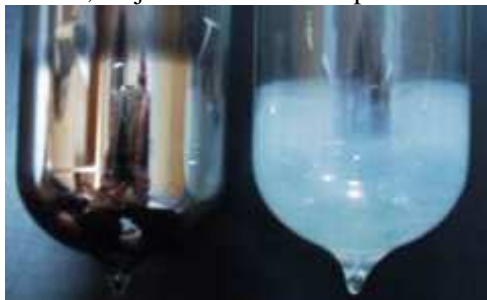
Nepoškodovana in poškodovana vakuumska cev
